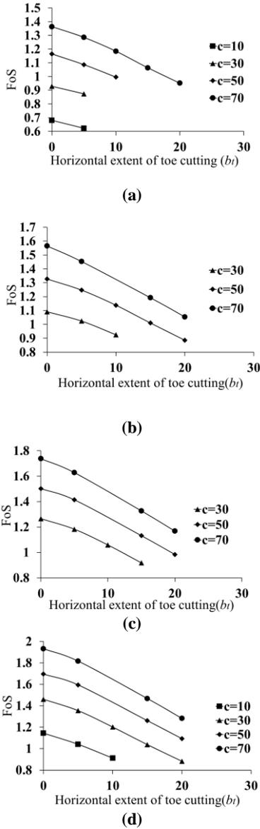
Fig. 3 Effect of toe cutting on dry hill slopes for  $\beta=40^\circ$ , (a)  $\varphi=20^\circ$  (b)  $\varphi=25^\circ$  (c)  $\varphi=30^\circ$  (d)  $\varphi=35^\circ$
